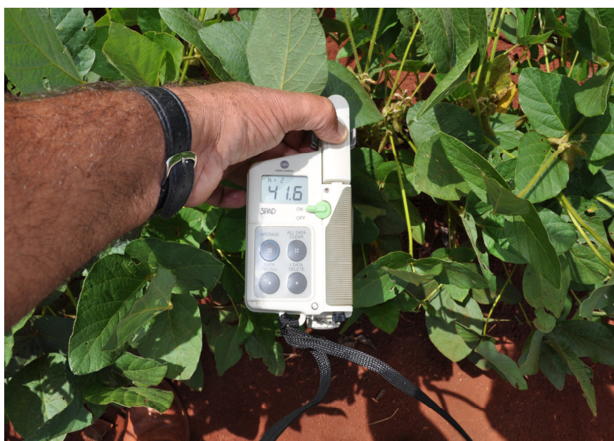
Figura 6. Aparelho utilizado para leitura a cerca do teor de clorofila (índice SPAD) apresentado pela folha da planta infectada pelo vírus. (Fonte: Juliatti, 2010).
