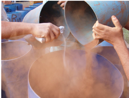
Figura 2 – Adição de agregados siderúrgicos.
