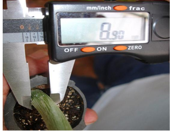
Figura 3. Medição do diâmetro de caule
