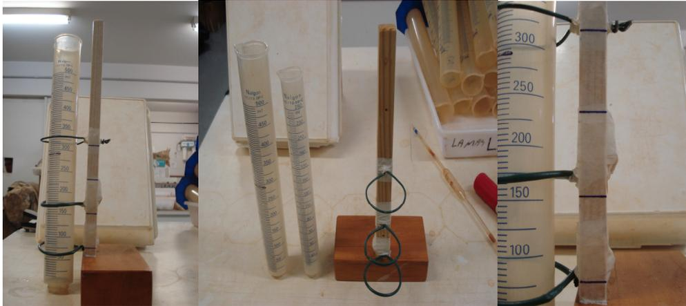
Figura 1. Fotos do suporte e provetas utilizados para determinação de densidade de substratos. Uberlândia - MG, 2010
