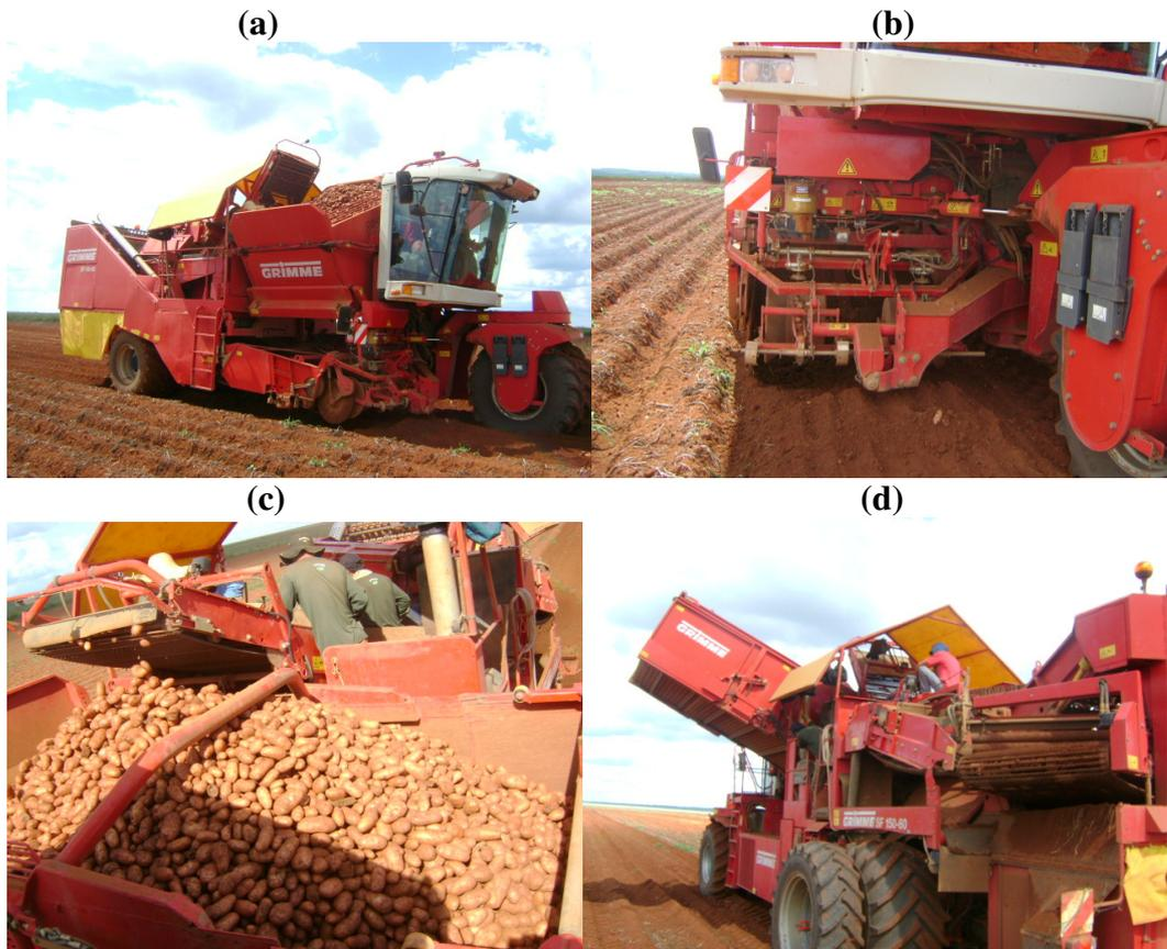
Figura 1 - Colhedora Grimme SF 150-60. (a): Vista geral da colhedora; (b): Detalhe do sistema de alimentação; (c): Detalhe do reservatório; (d): Detalhe do sistema de descarregamento.
