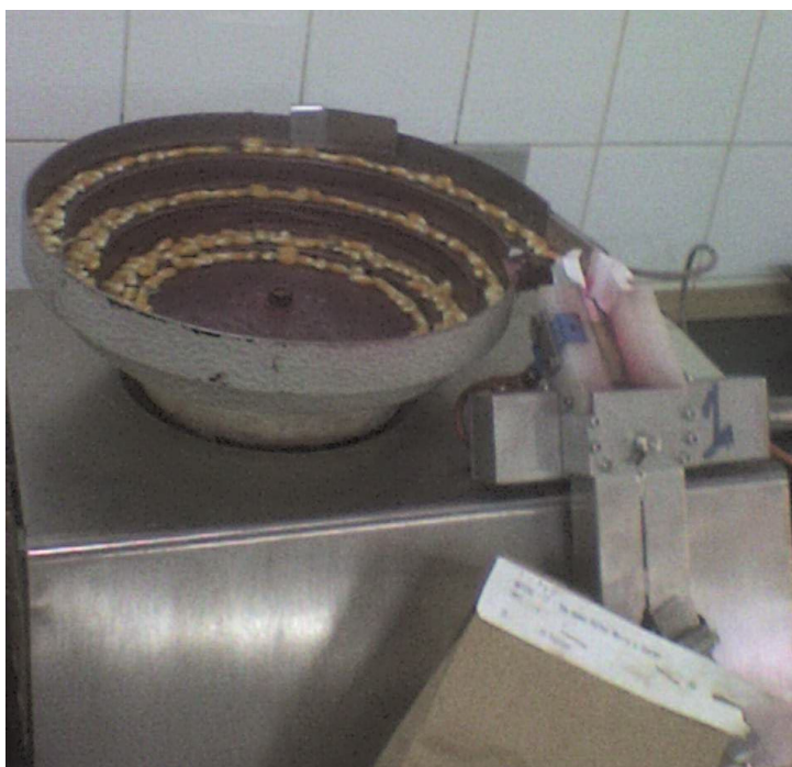
Figura 08 – Contador de grãos utilizado no ensaio em funcionamento. UFU, Uberlândia, 2009
