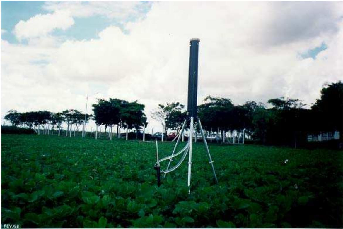
Figura 8. Permeâmetro de fluxo constante (Permeâmetro de Guelph).
