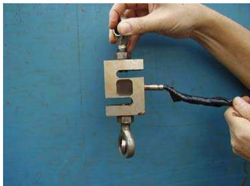
Figura 3 - Célula de carga do tipo “S”, utilizada na pesagem das mudas no plantio e dos colmos de cana na colheita.
