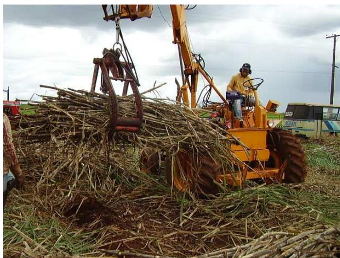
Figura 6 - Pesagem de um feixe de cana-de-açúcar através de uma célula de carga do tipo “S” e de uma balança eletrônica com precisão de 100 gramas modelo WT3000 adaptadas em um guincho recolhedor.
