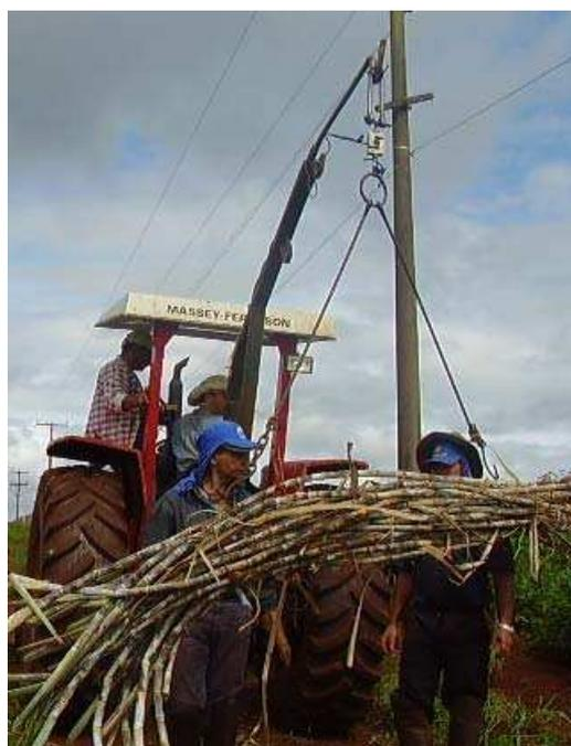
Figura 5 - Pesagem de um feixe de cana-de-açúcar através de uma célula de carga do tipo “S” acoplada a uma balança eletrônica com precisão de 100 gramas, modelo WT3000, adaptadas à traseira de um trator.
