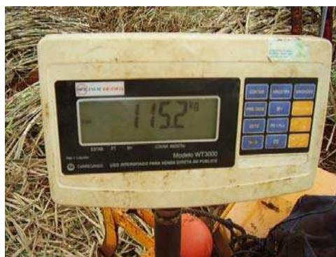
Figura 4 - Balança eletrônica modelo WT3000, com precisão de 100 gramas.
