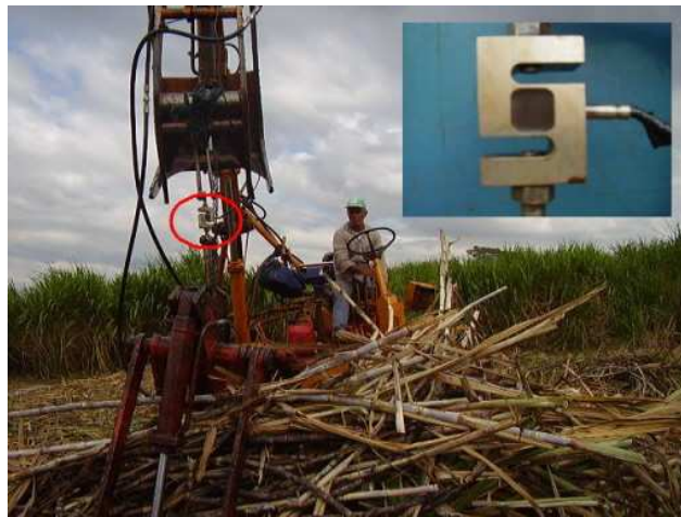
Figura 3: Detalhe da célula de carga tipo “S”, acoplada ao guincho recolhedor.
