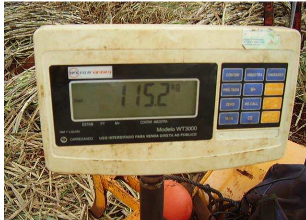
Figura 2: Balança eletrônica acoplada ao trator, com precisão de 100g.
