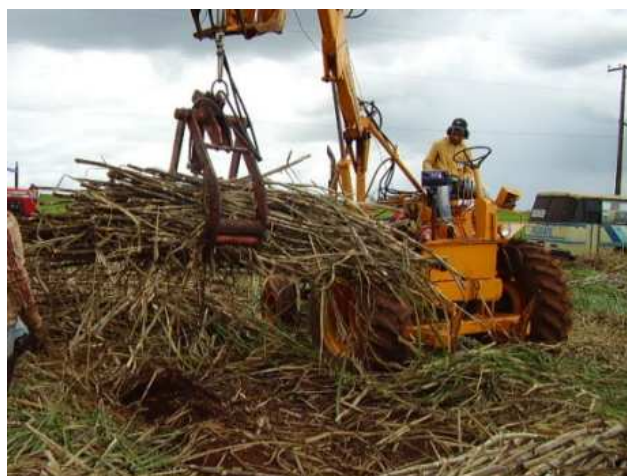
Figura 4: Guincho recolhedor no momento da pesagem.
