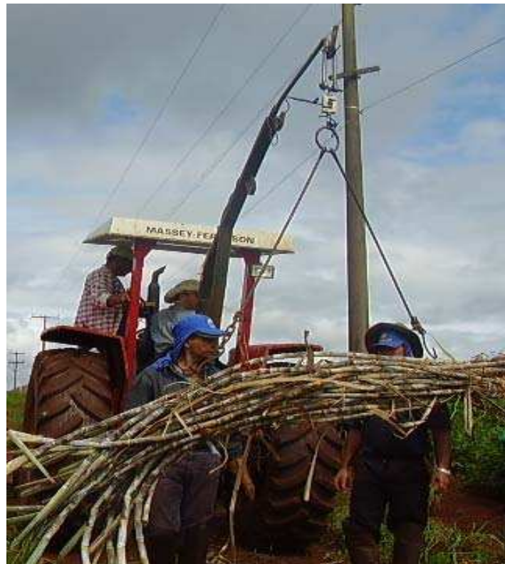
Figura 6 :Célula de carga tipo “S” e balança eletrônica no trator. Guaíra,2007.
