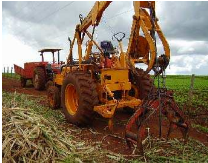
Figura 5: Detalhe do guincho recolhedor adaptado ao trator. Guaíra,2006.
