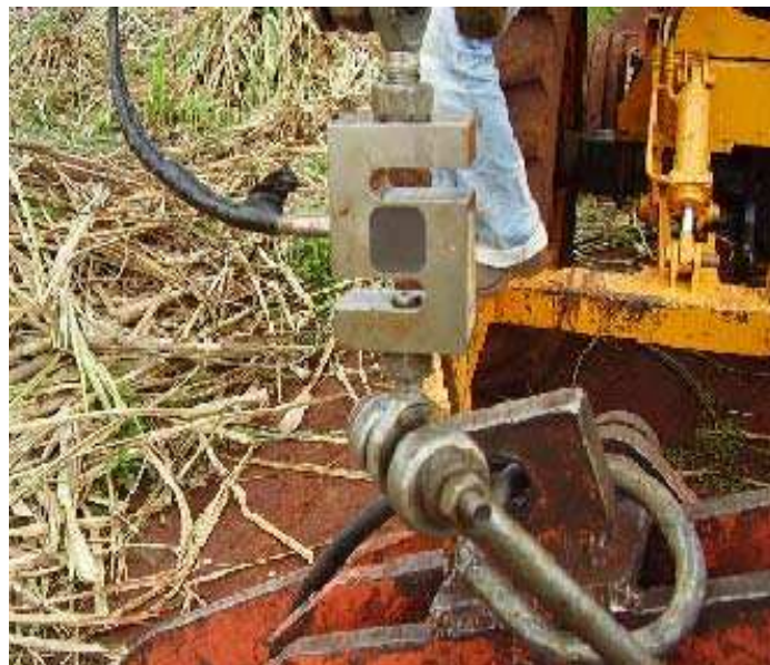
Figura 4: Célula de carga tipo “S” adaptada ao guincho recolhedor. Guaíra, 2006.
