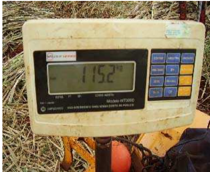
Figura 3: Balança eletrônica com precisão de 100 gramas. Guaíra, 2006.
