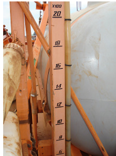
Figura 5 – Mangueira milimetrada utilizada para dosar a quantidade de dejetos. (Foto: Natália Bernardino)
