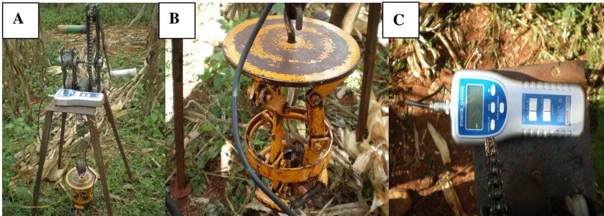
**Figura 10.** Arrancômetro (A), garra responsável por puxar o colmo (B) e célula de carga ou dinamômetro (C), Uberlândia-MG, 2008.
