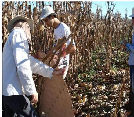
**Figura 2** – Inclinômetro: Equipamento utilizado para medir o ângulo e a força (Kgf) necessária para ocorrer o quebramento do colmo.
