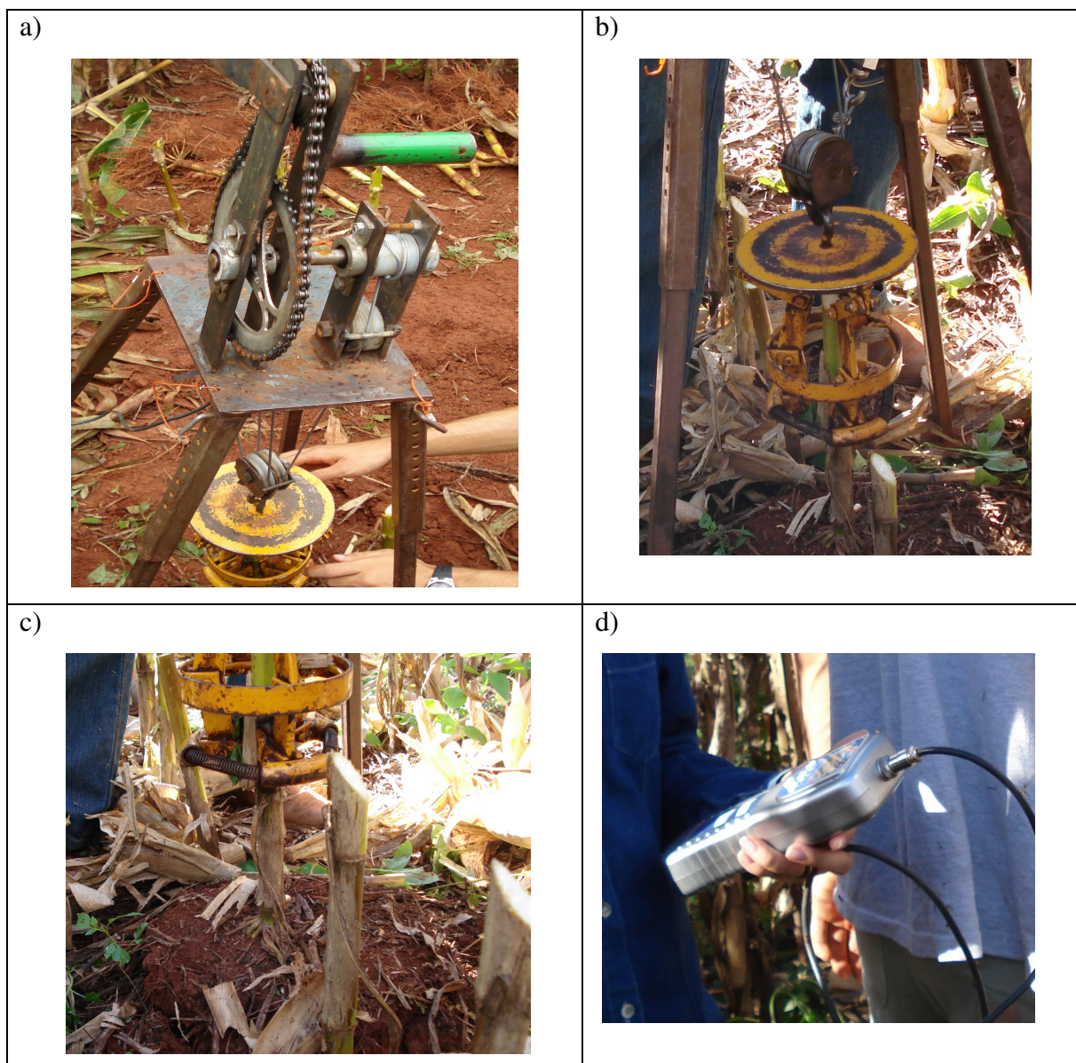
Figura 2: Arrancômetro, Uberlândia, 2008. a) Vista da mesa com garra, célula de carga, engrenagens e manivela. b) Garra de acoplamento no colmo. c) Visão da raiz após arranqui do planta. d) Leitor de força.
