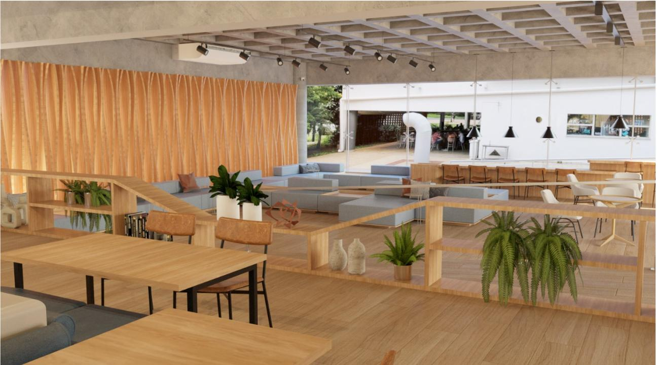
Fig. 83: Relação laje nervurada pendentes e spots em eletrocalha
