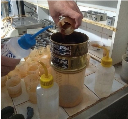
Procedimento de lavagem – utilização de piseta e água destilada
