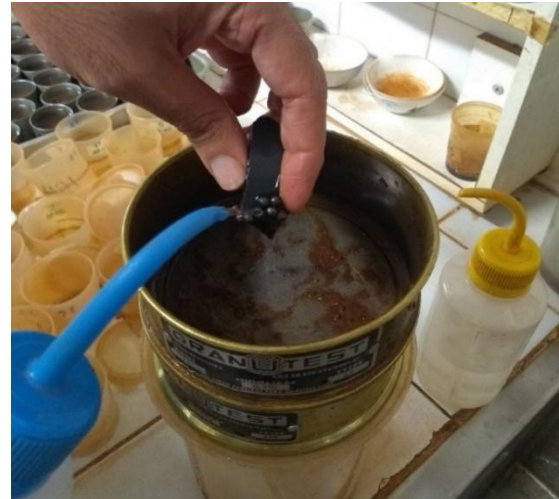
Procedimento de lavagem – utilização de piseta e água destilada
