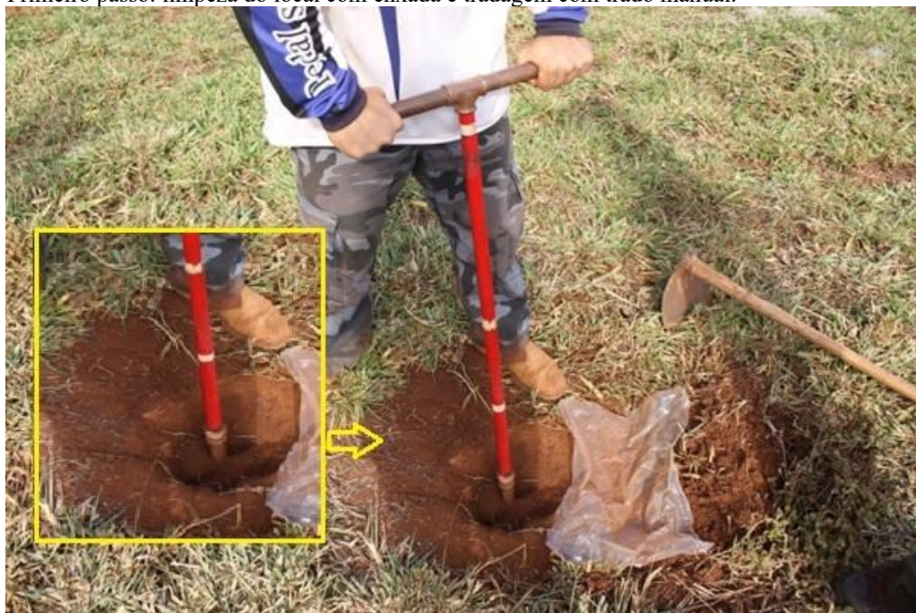
Foto 1 – Primeiro passo: limpeza do local com enxada e tradagem com trado manual.
