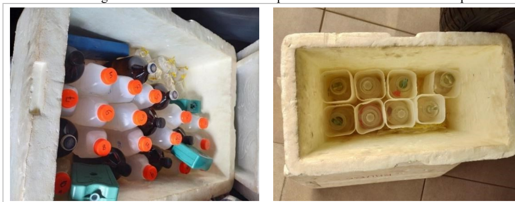
Figura 11 – Amostras de água coletadas e armazenadas temporariamente em seus devidos recipientes.
