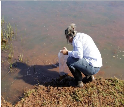
Coleta de amostras de sedimentos
