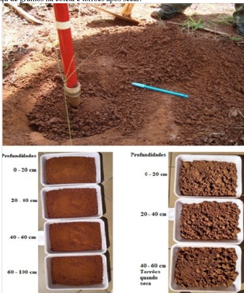
Figura 18 – Materiais Inconsolidados Residuais Pequena Espessura da Formação Serra Geral (ResPESG) nas BHCVT. Presença de grumos na coleta e torrões após secar.
