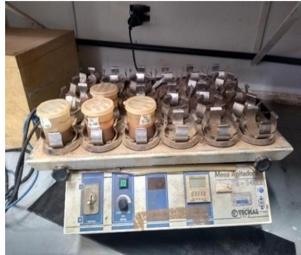
Mesa agitadora com as amostras em dispersão
