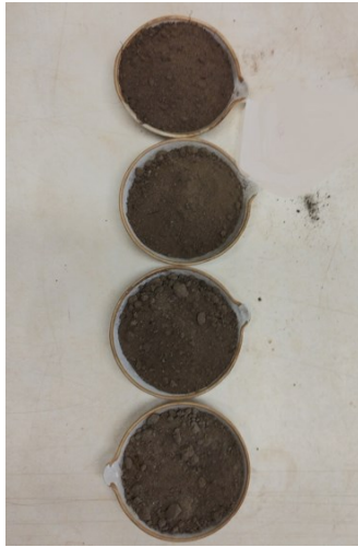
Amostras após secagem ao ar livre e antes de serem peneiradas
