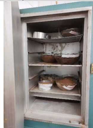
Secagem de amostras na estufa
