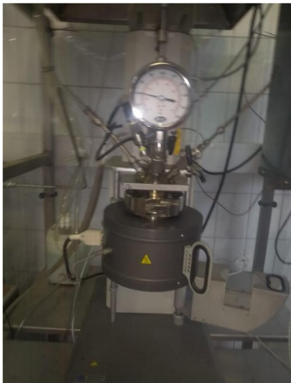
Figura 2.8 - Reator de carbonização hidrotérmica em escala a de bancada utilizado no trabalho de Silva et al. (2021)
