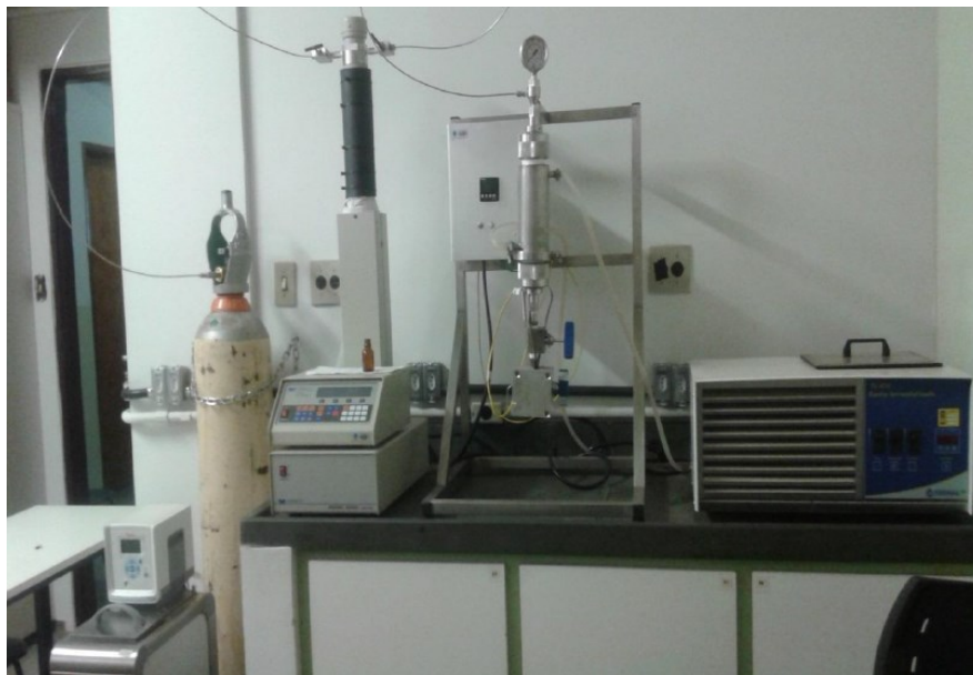
Figura 3.3 – Aparato experimental para pré-tratamento do bagaço de acerola em CO 2 supercrítico. Fonte: Autor
