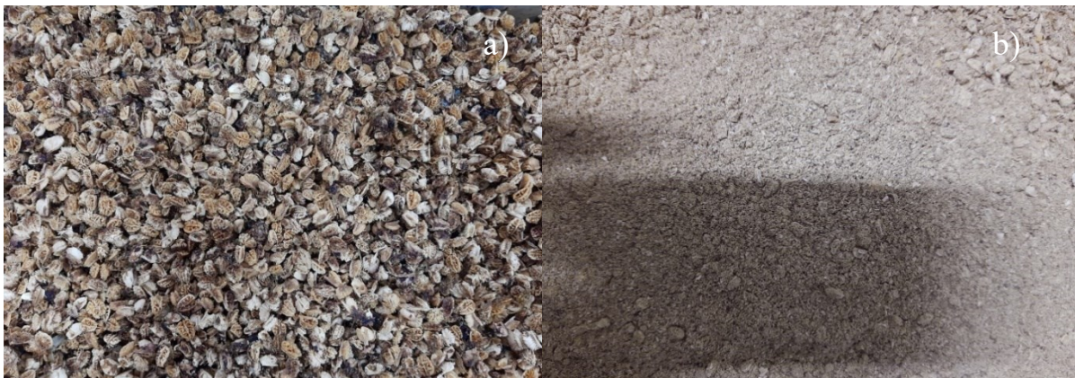
Figura 3.1 – Resíduo de acerola in natura (a) e triturado e separado na faixa granulométrica (b).
