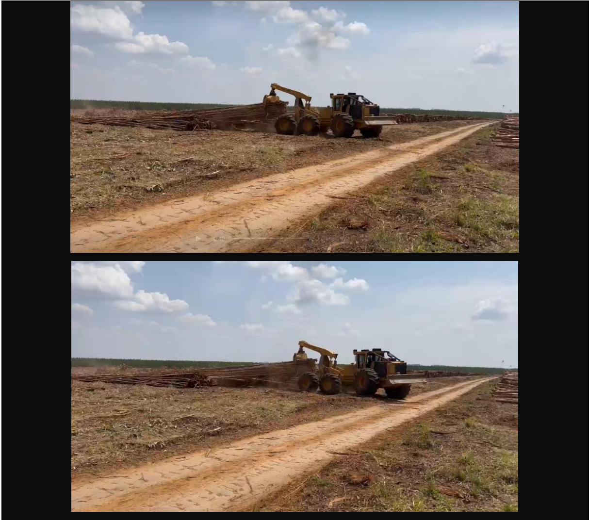
Imagem 10 – Operação de arraste duplo com skidder
