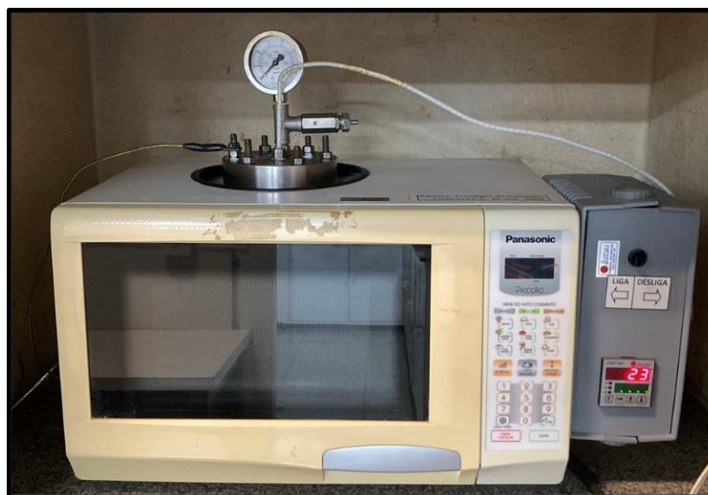
Figura 9 – Sistema hidrotérmico de micro-ondas aplicado na obtenção do ZnO e dos nanocompósitos de ZnO/Ag.
