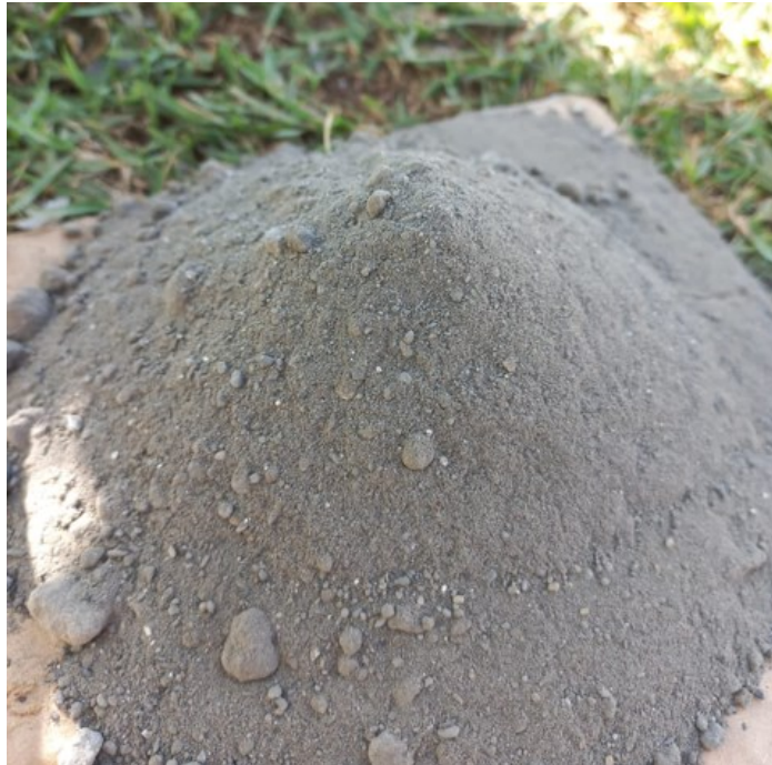
Figura 28 – Cinzas oriundas da combustão de cascas de eucalipto em caldeira de biomassa de indústria de celulose.
