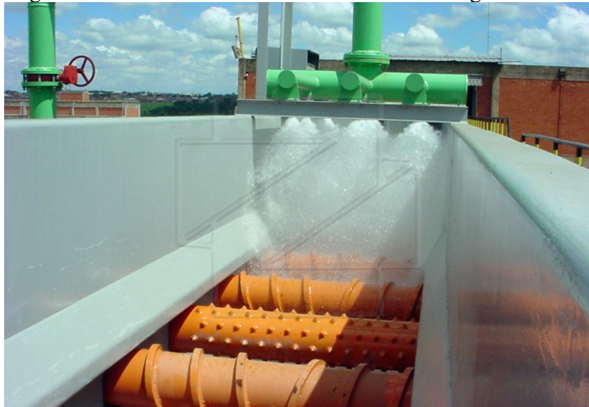
Figura 6 – Mesa de rolos crivados e sistema de lavagem de toras.
