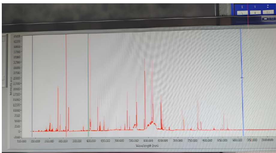
Figura 3.7 – Espectro fornecido pelo software do equipamento LIBS logo após a medida de uma amostra. Fonte: Autora.
