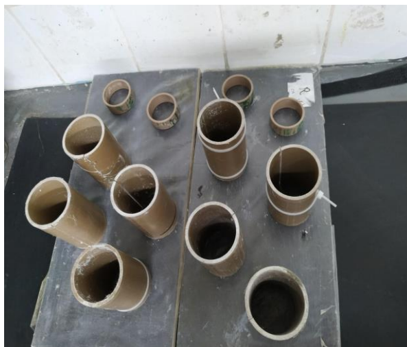
Figura 3.2 Molde utilizado para corpos-de-prova da argamassa. Fonte: Autora
