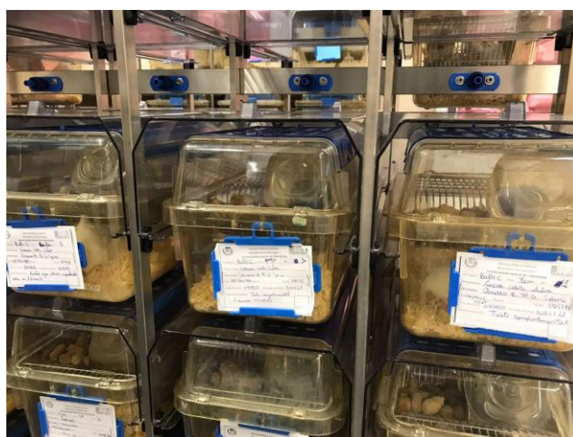
Figura 7: Caixas isoladas com sistema de exaustão que controla o fluxo de ar (REBIR – UFU)
