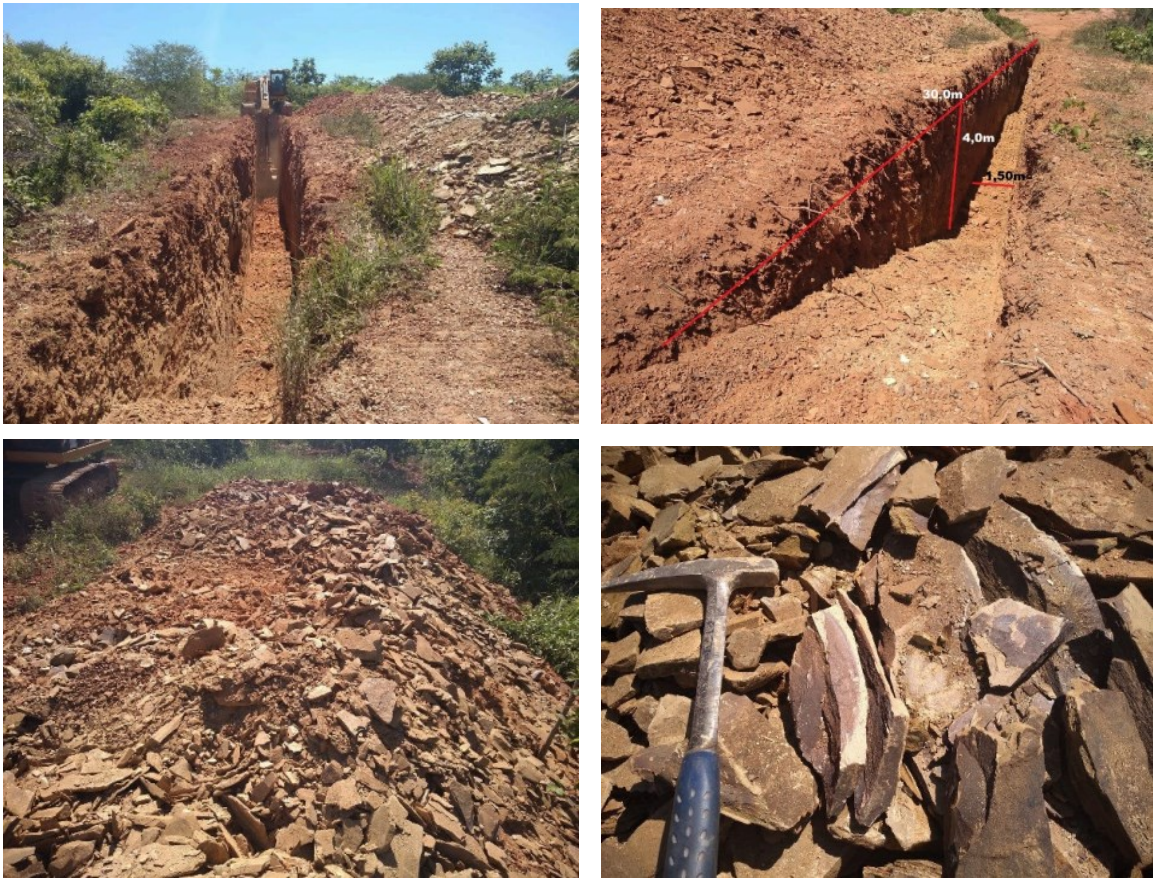
Figura 5- Imagens de uma das trincheiras abertas no local da mineração e do material retirado da trincheira
