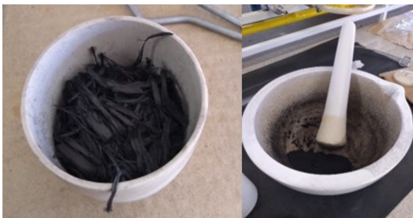
Figura 04: Biochar produzido na temperatura de 300°C peneirado nas granulometrias de 500 \mu\text{m} .
