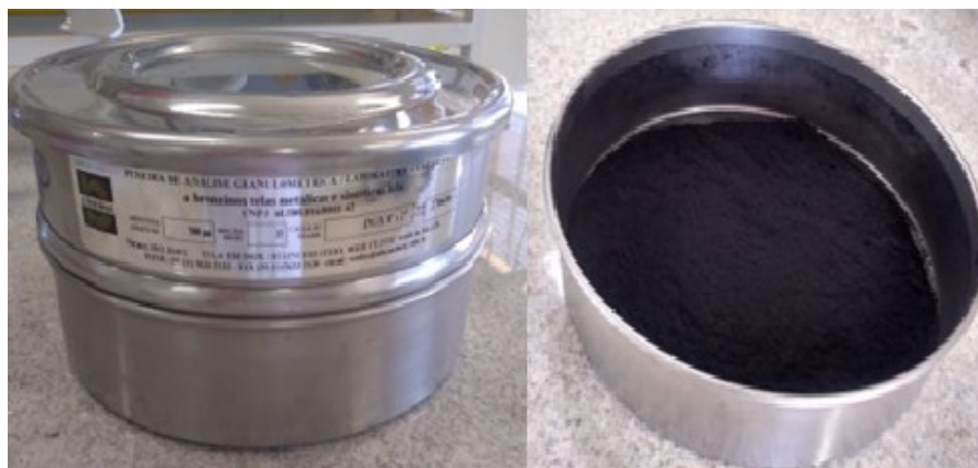
Figura 04: Biochar produzido na temperatura de 300°C peneirado nas granulometrias de 500 \mu\text{m} .
