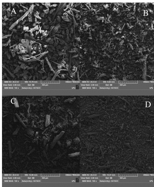
Figura 15: Micrografias do biochar no aumento de 500 \mu\text{m} . Sendo: (a) CE;(b) BC 300; (c)BCN; (d) BC@FE.
