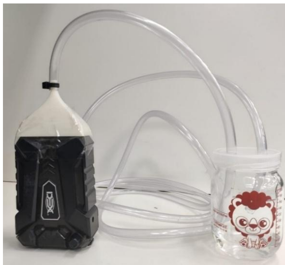
Figura 3.14 Sistema de fonte de odor.
