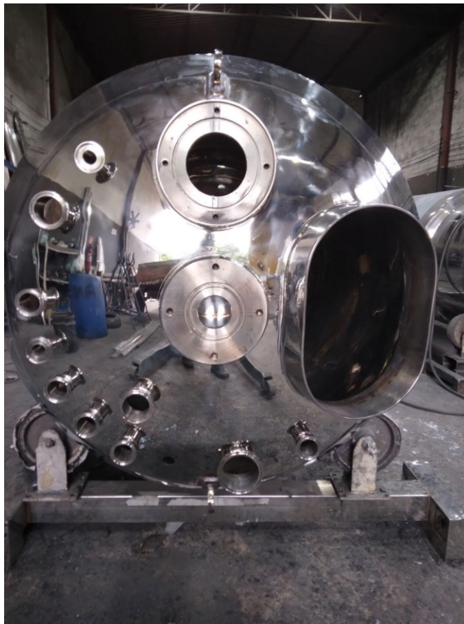
Figura 43 - Foto em Campo, tampo torisférico Superior com tomadas, para Tanque IRL-TT-500 INOX 316
