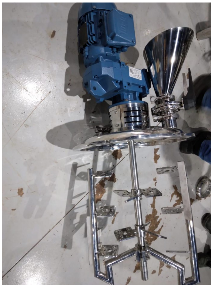
Figura 41 - Foto em campo, Tampo removível com sistema de agitação do tipo Âncora, para Tanque IRR-CC-50 INOX 316
