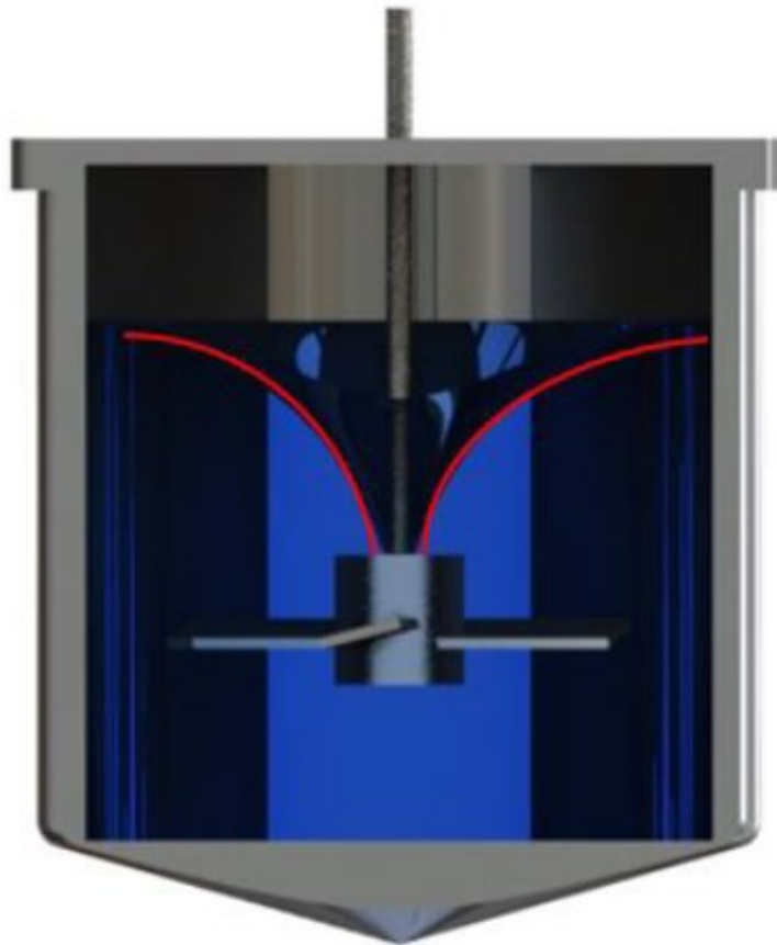
Figura 10 - Representação da formação de vortex (Baseado em Silva, 2002)
