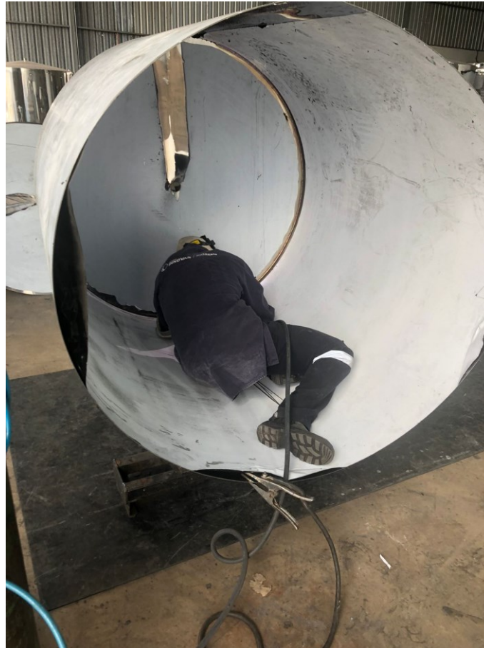
Figura 28 - Solda do tipo TIG, realizada em campo
