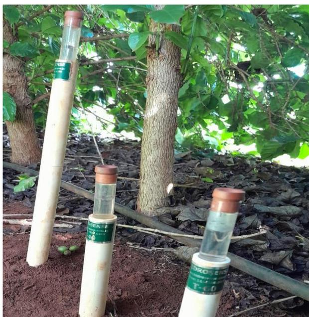
Figura 3. Tensiômetros para manejo da irrigação.
