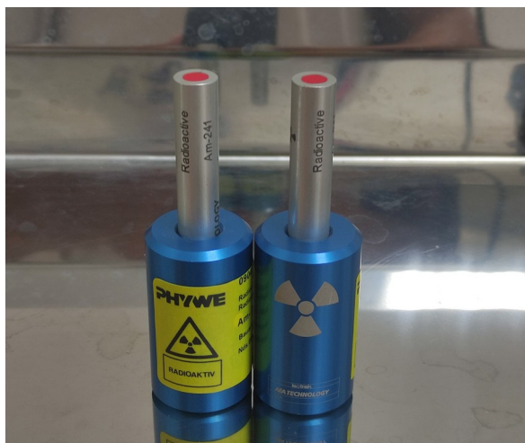
Figura 10: Fontes de Amerício-241 utilizadas nos experimentos deste trabalho. Fonte: O Autor (2024).
