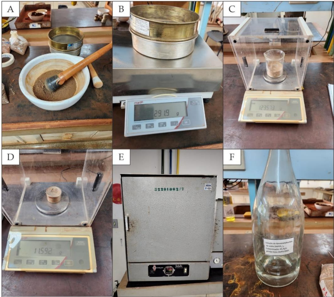
Figura 12: Processos para preparação das amostras para realizar o ensaio de sedimentação.
