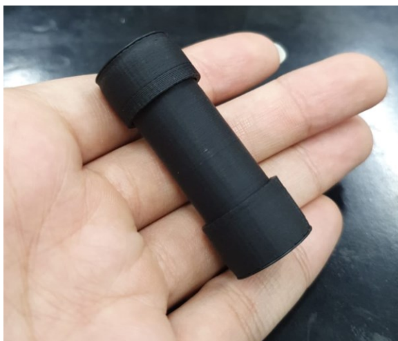
Figura 10. Dispositivo 3D cilíndrico confeccionado para teste de extração de SCP
