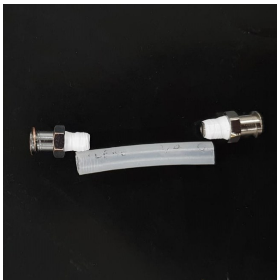
Figura 6. Itens usados para confecção dos cartuchos de teflon
