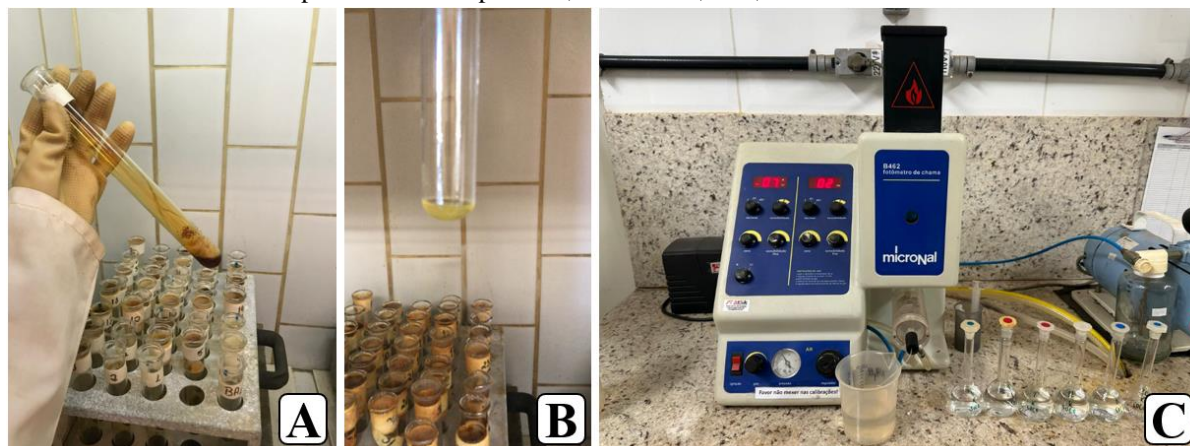
Figura 12 - A) Tubos com material durante a digestão foliar, B) Alíquota resultante da digestão foliar, C) Fotômetro de chama usado para a leitura de potássio, Uberlândia, MG, 2024.
