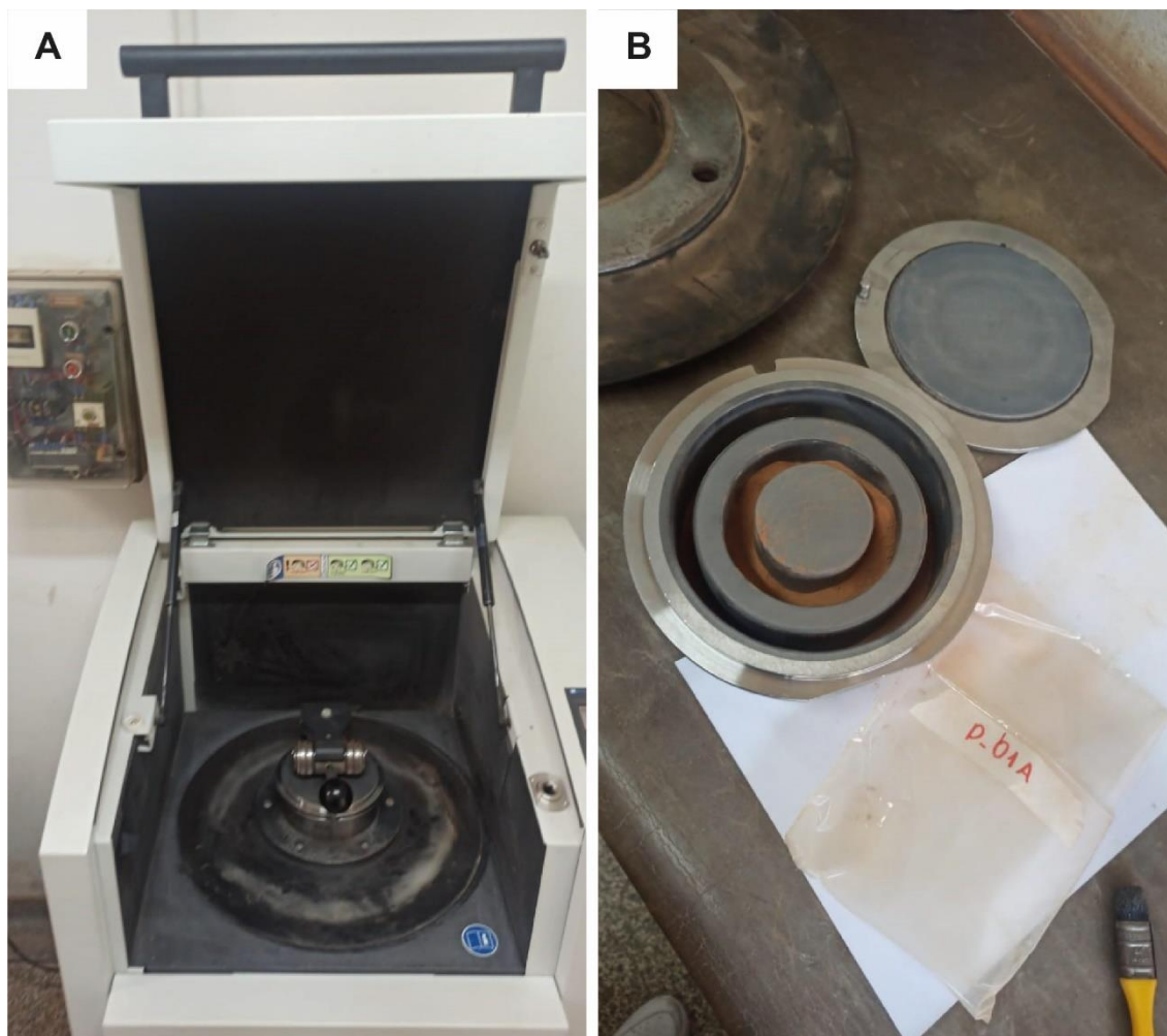
Figura 3: A) Moinho de bolas planetário da marca Retsch, modelo PM100, locado no Instituto de Geociências e Ciências Exatas da UNESP em Rio Claro. (B) Material resultante da fragmentação da amostra P01-A por meio de moinho de bolas.
