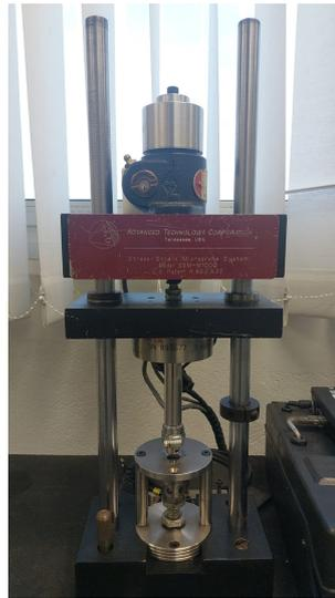
Figura 21 – Equipamento utilizado para realização do ensaio de indentação esférica.
