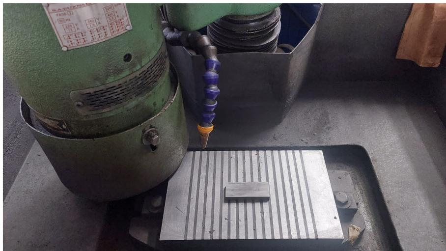
Figura 19 – Equipamento utilizado para retificação das amostras.
