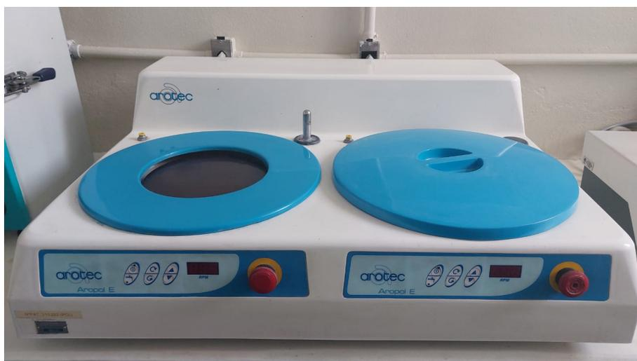
Figura 20 – Equipamento utilizado para lixamento e polimento das amostras.
