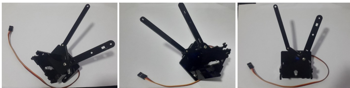
Figura 4.7 – Junção da base com a haste maior do manipulador robótico.
