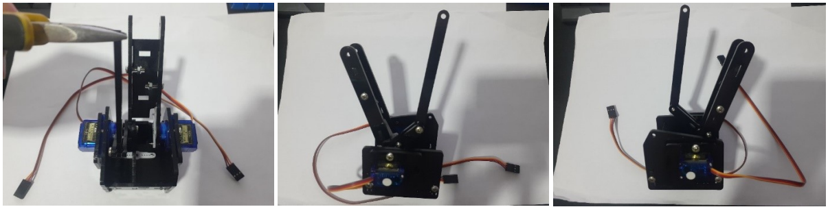
Figura 4.8 – Junção da haste menor no manipulador robótico.
