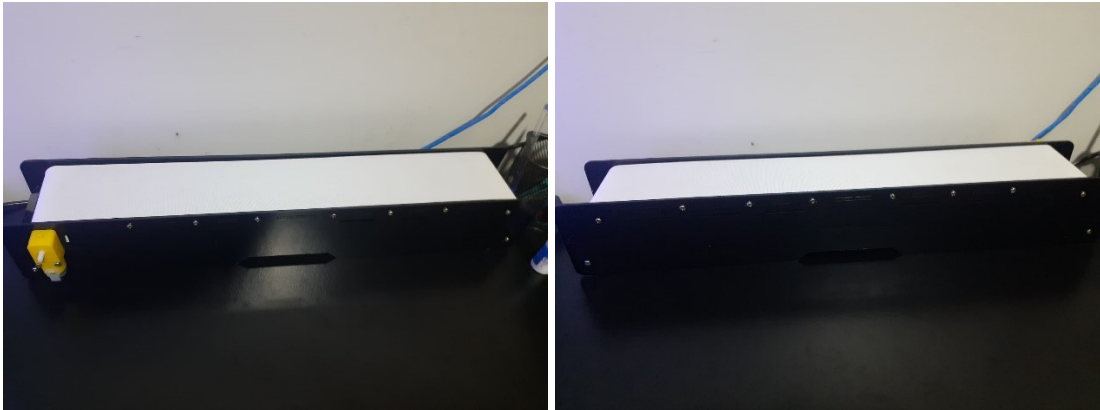
Figura 4.12 – Esteira Transportadora (Frente e verso).
