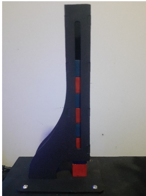
Figura 4.20 – Dispenser com blocos no projeto final.
