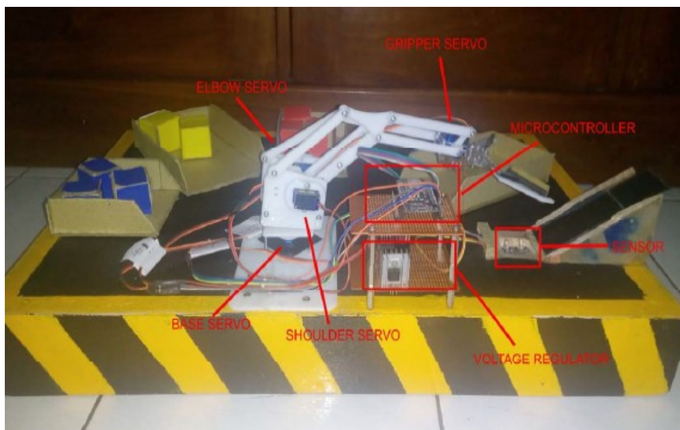
Figura 1.2 – Projeto de um manipulador robótico que separa componentes com colorações diferentes.
