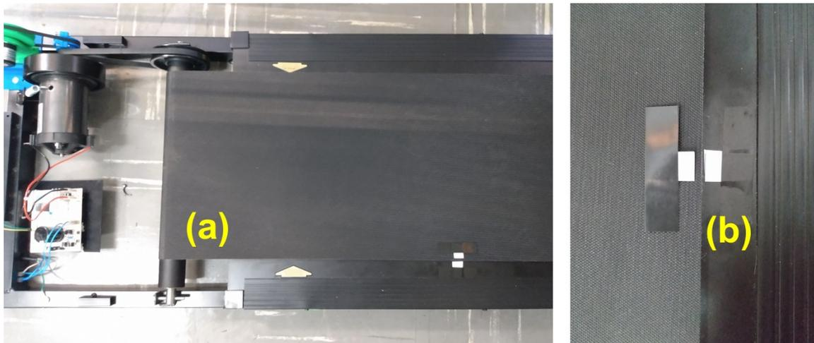
Figura 16 – Experimento de medição de velocidade. Vista geral da esteira com marcações (a) e vista ampliada dos marcadores utilizados para cronometragem do tempo de uma volta da lona (b).
