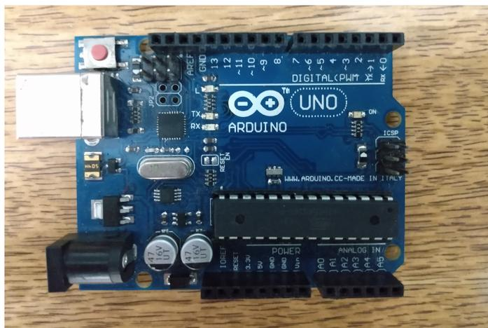
Figura 20 – Controlador Arduino UNO utilizado para controlar a velocidade das esteiras.
