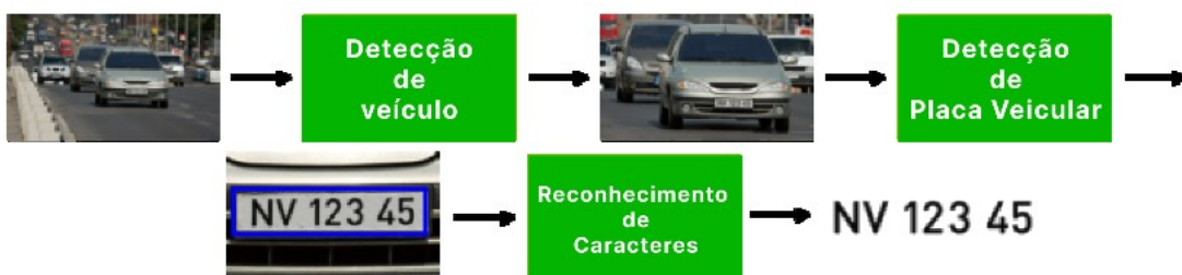
Figura 1.2 – Exemplo de Etapas de Desenvolvimento de um Sistema ALPR
