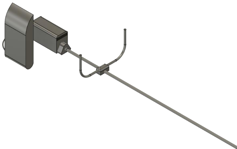
Figura 33: Representação do protótipo com capa de proteção dos componentes, guidão e cano de acoplamento dos acessórios.
