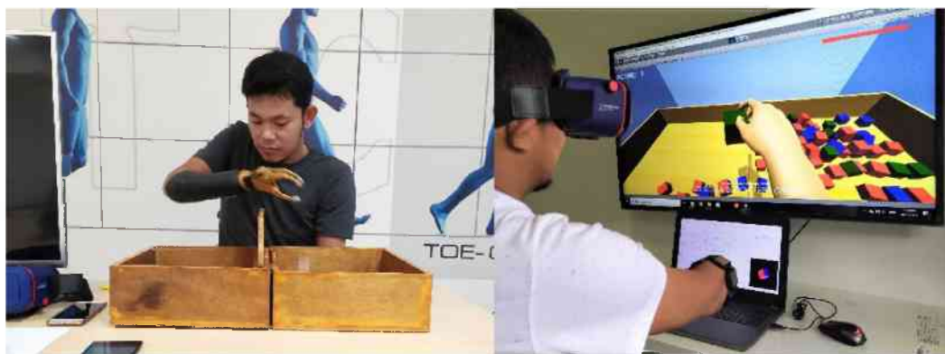
Figura 10 - Teste BBT em método convencional (esquerda) e virtual (direita).
