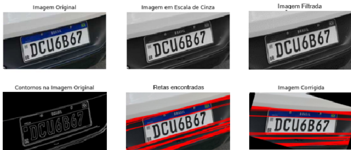
Figura 3.9 – Processo de detecção de angulação pelo método de Hough.
