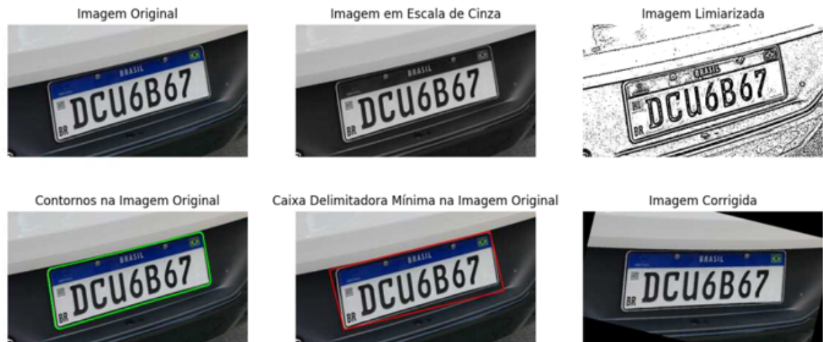
Figura 3.8 – Processo de detecção de angulação pelo método do retângulo de área mínima.
