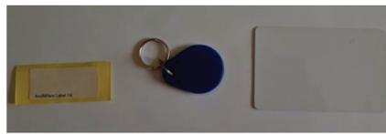
Figura 2: Etiquetas RFID comumente utilizadas
