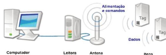
Figura 1: Elementos de uma sistema RFID
