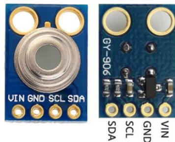
Figura 7 – Sensor de temperatura MLX90614.
