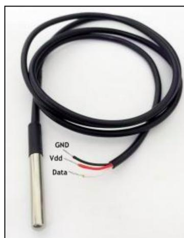
Figura 8 – Sensor de temperatura DS18B20.
