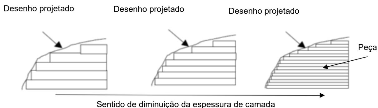
Figura 2.7 – Representação do efeito escada de acordo com a diminuição da espessura de camada depositada (Adaptado de Harun *et al.*, 2018).
