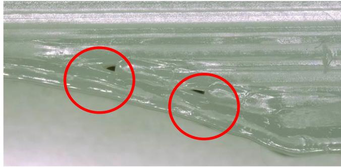
Figura 2.21 – Falha apresentada entre a parte externa e interna da peça (Adaptado de Letcher e Waytashek, 2014).
