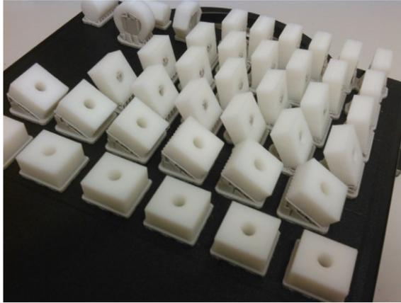
Figura 2.15 – Peças fabricadas por Fabricação de Filamento Fundido (FFF) com diferentes ângulos de inclinação de deposição (BOSCHETO, BOTTINI E VENIALI, 2016).
