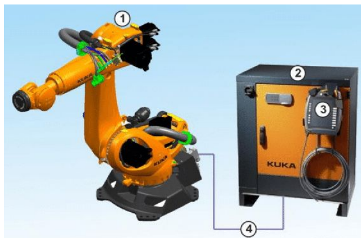
Figura 4 – Arquitetura básica para um robô industrial comercial que contém: 1) manipulador robótico, 2) gabinete, 3) teach-pendant e 4) cabeamento.
