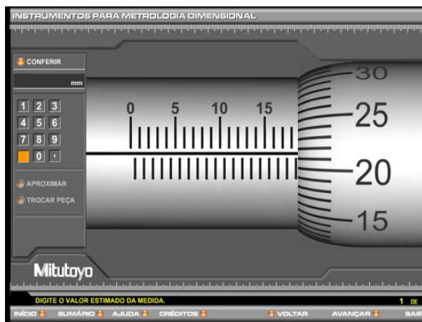
(d) Imagem ampliada das escalas do micrômetro analógico sem nônio.
