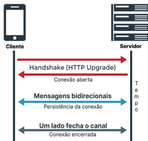
Figura 4 - Procedimento de conexão WebSocket
