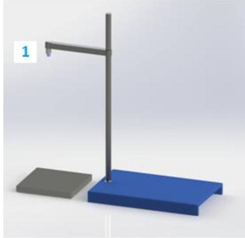
Figura 3.5: Aparato para medida experimental do coeficiente de restituição dos grãos de café.
