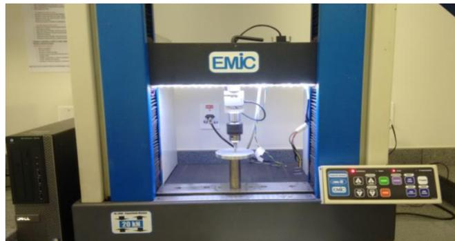
Figura 3.6: Equipamento utilizado para realizar ensaios de compressão para o café verde.
