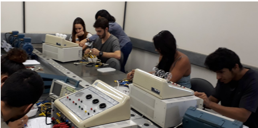
Figura 8 - Kit Data Pool utilizados nas aulas práticas de Eletrônica de Potência.
