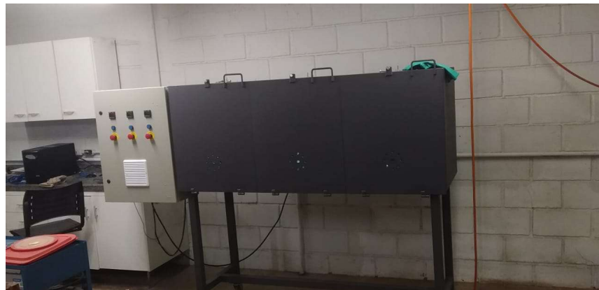
Figura 4 - Unidade experimental de envelhecimento térmico para fluidos de perfuração
