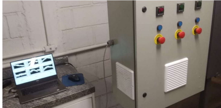
Figura 5 - Sistema de controle e aquisição de dados para unidade experimental de envelhecimento térmico
