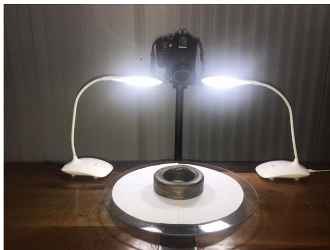
Figura 11: Vista frontal da bancada para o registro das fotografias utilizadas na confecção do modelo 3D a partir do processo de Fotogrametria.
