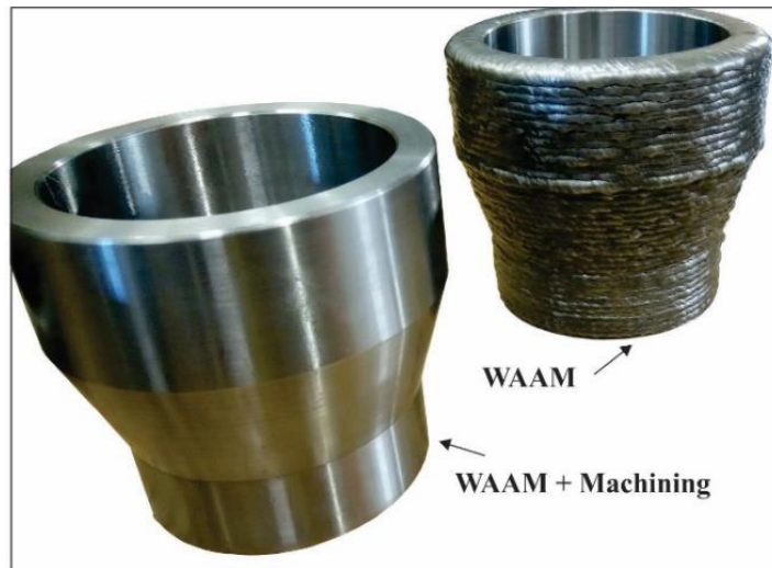
Figura 1: Primeira peça fabricada por Manufatura Aditiva (MADA) aplicada em uma instalação de petróleo e gás no Brasil.
