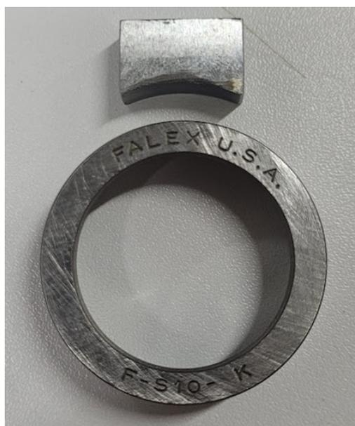
Figura 3.4 – Corpo de prova e anel contracorpo (fonte: autor)
